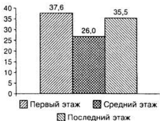
Рис. 1. Частота поражения стеновых конструкций грибковой флорой в зависимости от этажности зданий.
